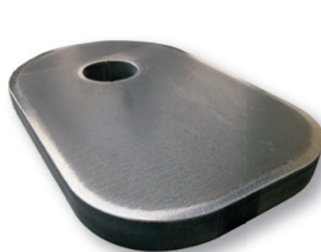
Doskonałe gratowanie ograniczone tylko na krawędzi
