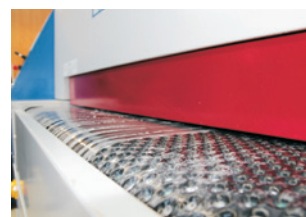
Stół transportowy maszyny wraz z systemem próżniowym wakuum
