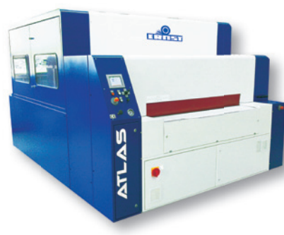
ATLAS ER (gratowanie + silne zaokrąglanie)
