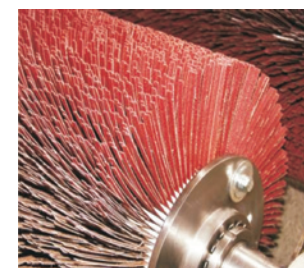
Zaokrąglenie krawędzi (dwie szczotki lamelkowe)
