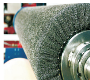
Zatępienie krawędzi (2 szczotki ze stali nierdzewnej)
