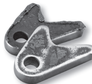
Bezproblemowe usuwanie nawet bardzo dużej wypływki
