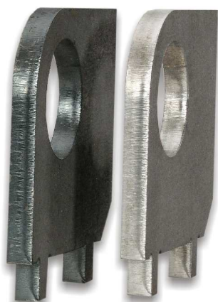
Detale przed i po procesie usuwania warstwy tlenku
