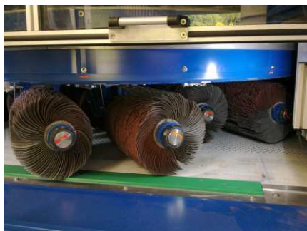
Maszyna umożliwia silne i równomierne zaokrąglenie krawędzi blach 1 - 100 mm.
