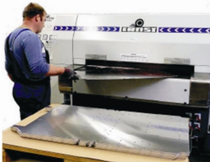
Właśnie podaje się detale do pierwszej części maszyny EM 5 N II/L1400. Dzięki niej, LTI udowadnia swoje kompetencje w zakresie obróbki blach.
